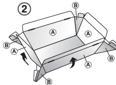
Plier les côtés **A** en dedans et poser le moule de manière à ce que les surfaces **B** soient en dehors.
