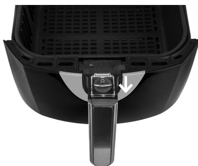
3. Far scorrere il recipiente di cottura nel dispositivo, più precisamente nella camera di cottura.
