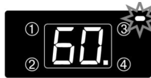
**14.** Nach Erreichen der eingestellten Reifezeit ertönt ein 3-maliger Signalton, das Programm ist beendet und das Gerät schaltet sich erst in den Betriebs-Modus und nach weiteren 30 Sekunden in den Standby-Modus, sollte keine Taste mehr gedrückt werden.
