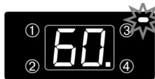
**14.** Une fois le temps de fermentation écoulé, un signal sonore retentit 3 fois, le programme est fini et l'appareil passe tout d'abord sur le mode de fonctionnement puis au bout de 30 secondes sur le mode de veille, si vous n'appuyez sur aucune touche.
