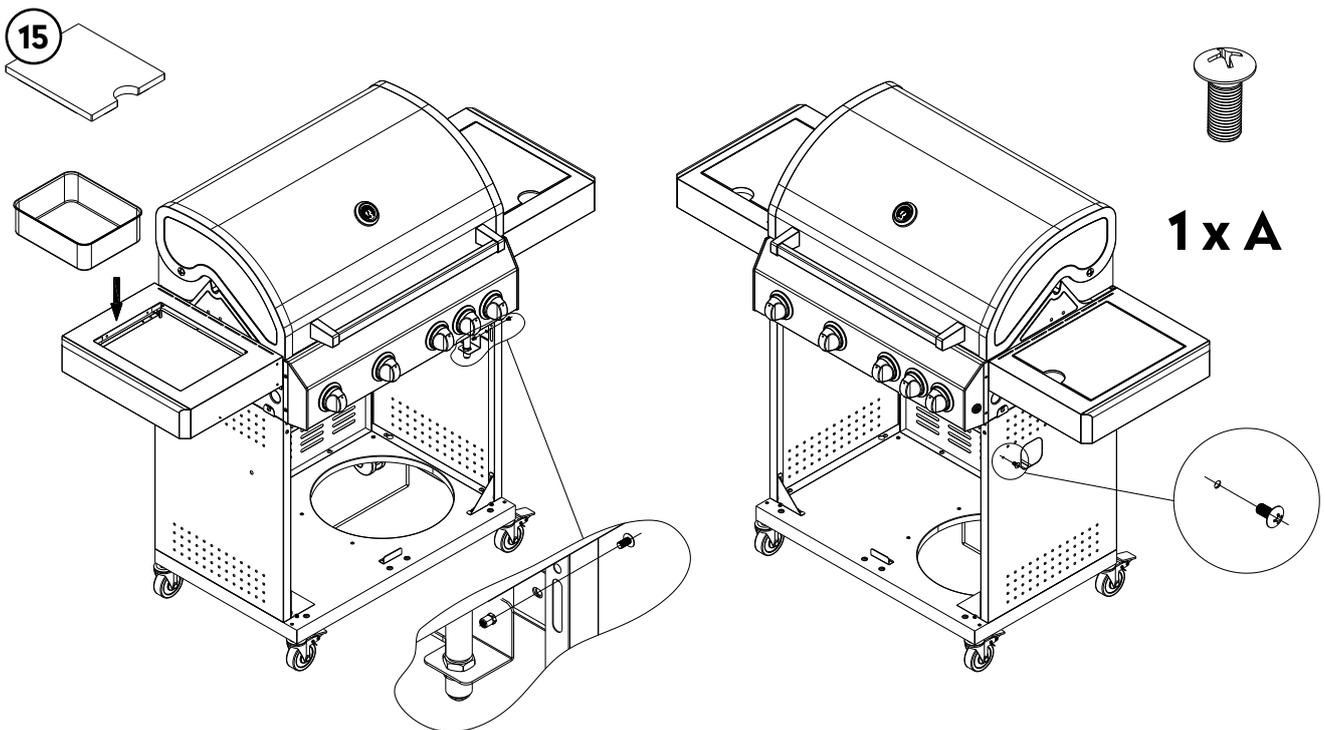
Der Gasanschluss ist für den Transport mit einem Kabelbinder unter der Konsole befestigt. Löse den Kabelbinder und schraube den Gasanschluss an die Seitenwand des Grills.
