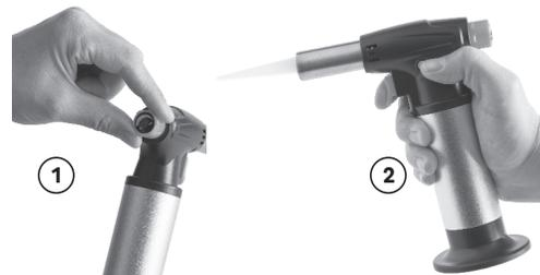
**Hinweis:** Die Flammenstärke kann während des Betriebes mit dem Feuerregelventil reguliert werden. Drehen gegen den Uhrzeigersinn (Richtung +) wird die Flamme intensiver, drehen im Uhrzeigersinn (Richtung -) wird die Flamme schwächer.
