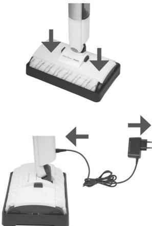
5. Um die Selbstreinigung zu starten, halten Sie für 5 Sekunden die Taste für die Sprühfunktion (C) gedrückt. Nun werden die Rollen während der folgenden 2 Minuten abwechselnd befeuchtet und gewaschen, das grüne Licht blinkt während des Vorgangs.
