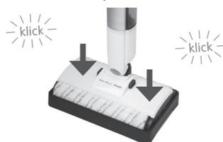
**5.** Avant de commencer le nettoyage, le rouleau avant doit être humidifié afin de garantir une humidification uniforme du sol et d'éviter les traces d'eau. Retirez pour cela le rouleau avant (voir page 41, à droite) ; le rouleau arrière doit rester sec pour sécher le sol) et humidifiez le rouleau avant à la main sous un robinet.
