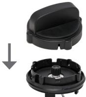
3. Tenez l'ensemble porte-lames au niveau du cache et insérez l'ensemble porte-lames dans l'embase. Tournez l'ensemble porte-lames dans le sens des aiguilles d'une montre jusqu'à la butée.
