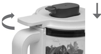
**4.** Placez le bol sur le socle de l'appareil de manière à ce qu'il repose correctement dessus et que les flèches de l'unité moteur et du bol soient bien au-dessus les uns des autres (position X).
