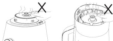
Pour ne pas vous brûler avec l'élément chauffant, nous vous recommandons de le recouvrir avec le cache pour visser/dévisser l'ensemble porte-lames (9) en appuyant légèrement sur le cache. **Attention :** Le cache peut être également chaud.
