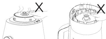
Per non scottarsi con l'elemento riscaldante, si consiglia di coprire quest'ultimo con il coperchio per avvitare e svitare l'unità motore (9), premendolo leggermente verso il basso. **Attenzione:** il coperchio potrebbe riscaldarsi.
