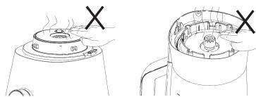
Um sich nicht an dem heißen Heiz-element zu verbrennen, empfehlen wir, dieses mit dem Deckel zum Auf- und Abschrauben der Messereinheit (9) abzudecken und den Deckel dabei leicht anzudrücken. **Achtung:** Der Deckel könnte warm werden.
